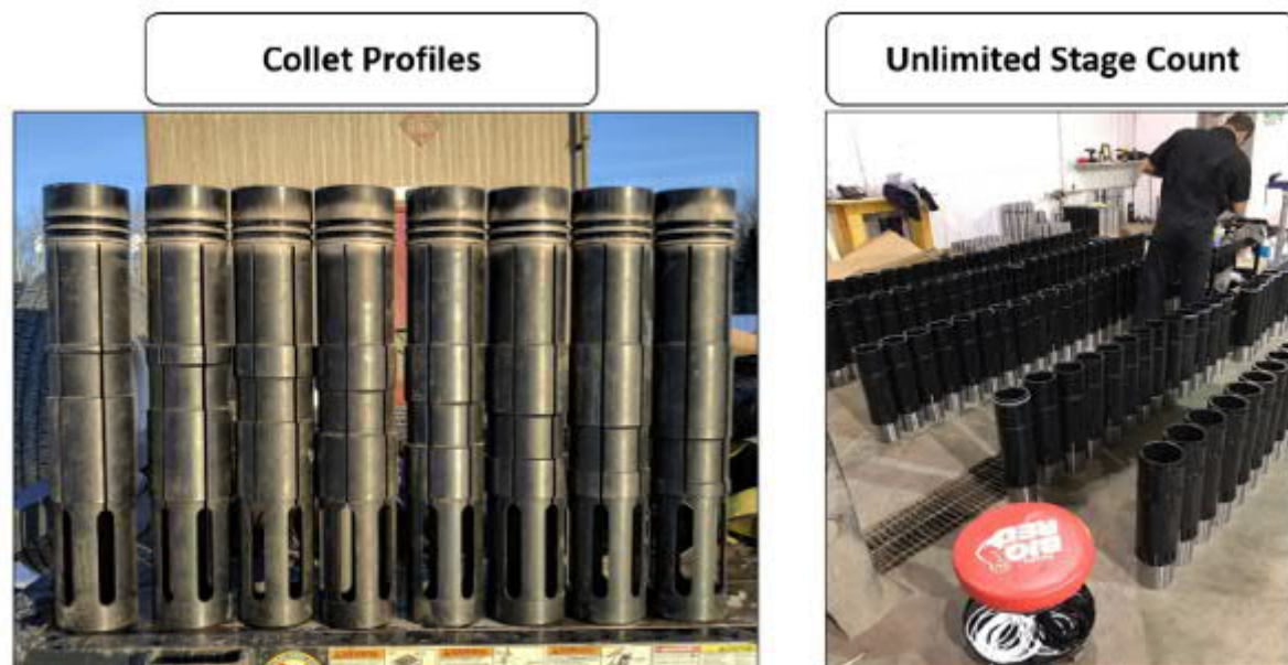
Рис. 5. Равнопроходные муфты Stages и ключи (collets) для шаров для их открытия
